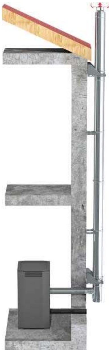
Figure 7a – Montage en situation extérieure Conduits DW-ECO 316 2.0
