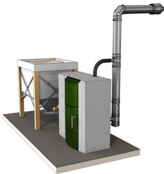
Figure 8 – Principe de raccordement à une chaudière à granulés avec un té ou un coude en pied de conduit
